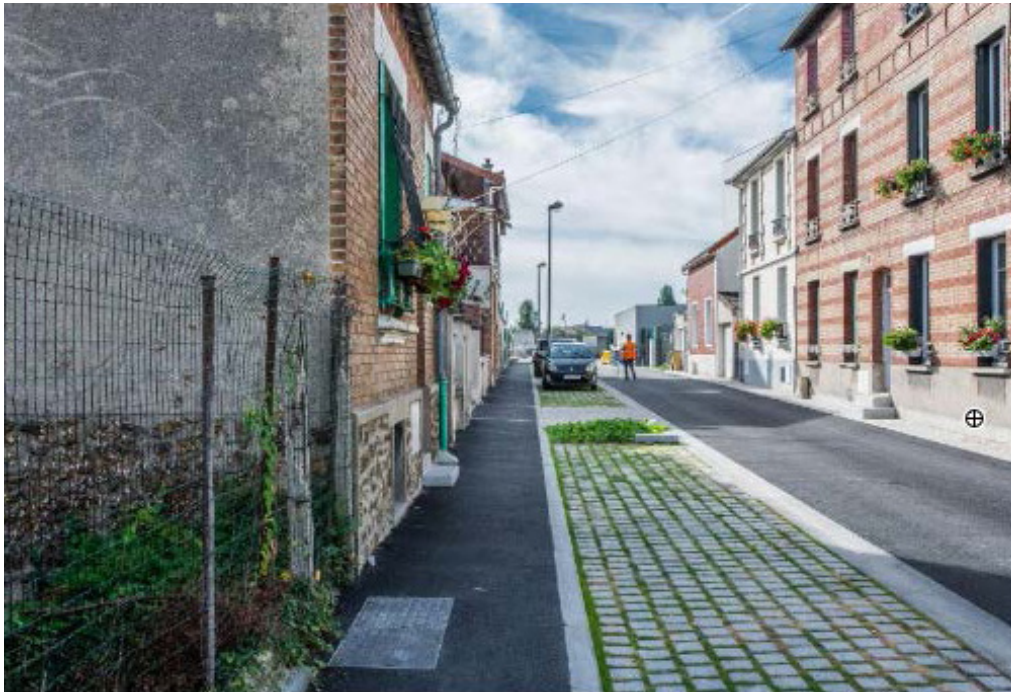
Photo 5: exemple de revêtement avec pavés en pierre et joints enherbés (Source photo: https://www.atelierphilippemadec.fr/amenagementurbain/espaces-publics/reamenagement-de-la-ruedes-jardins-dufour.html )
